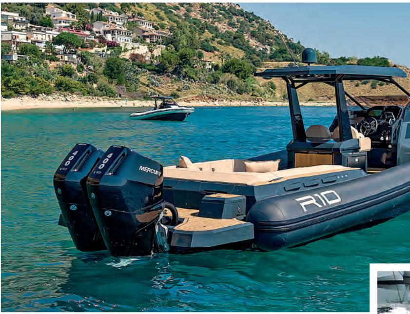
Montando los motores sobre bracket se obtiene una cómoda zona para el baño.
